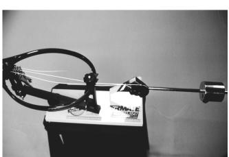
すると、写真のように「ストリングジョー」が閉じてストリングをつかみます。
