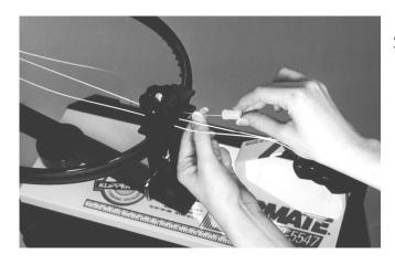
さあ、トップフレームにある、次にストリングを通す予定の空いたホール (A-5-2 ページのストリングガイド図の L2) に、「スタートピン」を突き刺してください。 (メンテナンスパックにある小さな工具です) (内容物写真参照)
