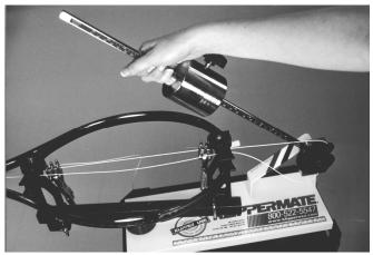
「テンションロッド」を元の左斜めポジション(アップライトポジション)に戻し、ストリングを「ストリングジョー」 から外してください。
