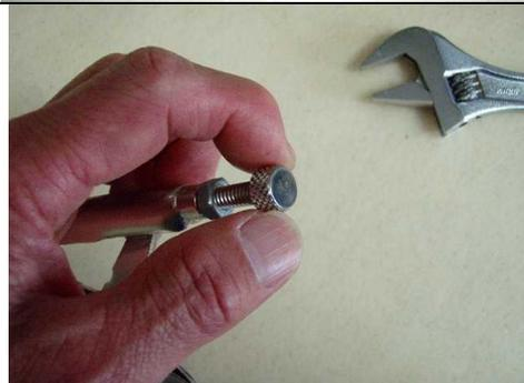
注意：ダブルストリングクランプにクランプした時、歯のようになっている先端部から 12 ミリ程度下部から 4 本のボルトの上部、おおよそ 3 ミリ程度の間の位置で止めてください。
