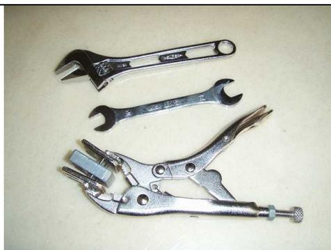
2. ナットをゆるめた後、丸いネジ (リューズ) を右に回すと強く締まり、左に回すとゆるみます。リューズ調整後、ナットを再び締めて下さい。今後の調整のため、あまり強く締め付けしないで下さい。
