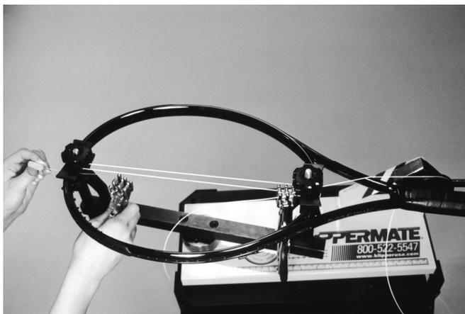
ストリングにテンション（張力）がかかっている間に、トップフレーム側の「ダブルストリングクランプ」と「スタートピン」を外してください。（「スタートピン」はこの時に一度使うだけです）
