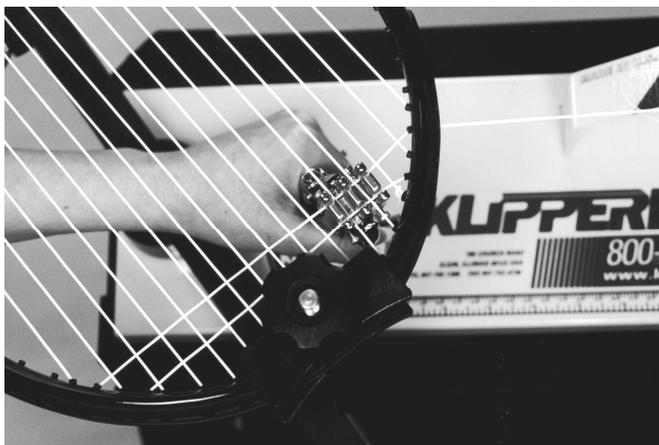
1本目・二本目のクロスストリングにテンションをかけた後、テンションをかけたまま、「ダブルストリングクランプ」で2本のクロスストリングをクランプしてください。
