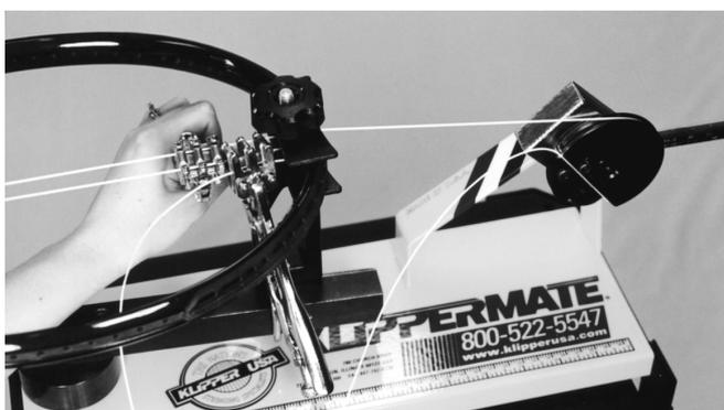
ストリングにテンション（張力）がかかっている間に、引っぱられている2本のストリング（左右の中央メインストリング）（A-5-2 ページのストリングガイド図のL1 とR1）を、先にクランプした「ダブルストリングクランプ」にくっつけるようにクランプ（挟み込む）します。
