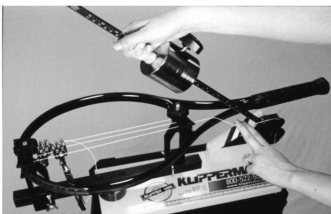
ラケットのグリップ部が「テンションロッド」の奥側（人から見て）になるように、ラケットを180度回してください。最も近くのストリング（左側メインストリング）をトップフレームの次（すぐ横）（A-5-2 ページのストリングガイド図のL2）のホールに通し、さらに対応するスロートエリアのホールまで通します。
