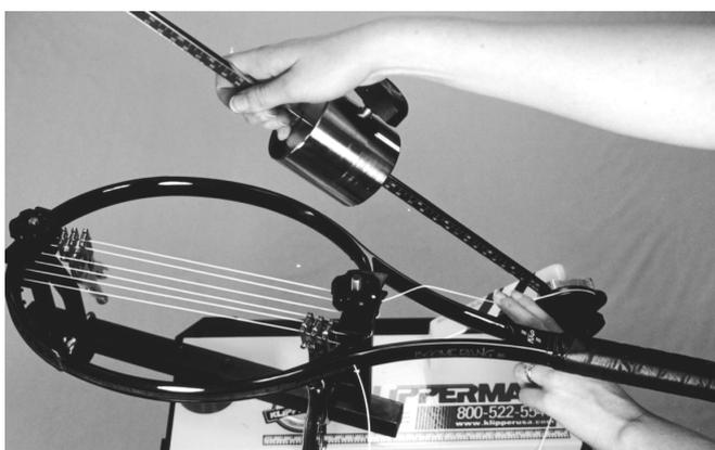
「ストリングジョー」にストリングを引っ掛け、ストリングにテンション（張り）をかけてください。
