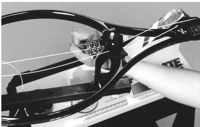
テンションが効いている間に、もう一つの「ダブルストリングクランプ」で「スタートピン」とストリングをテンション維持のためにクランプ（挟み込む）してください。
