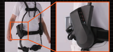
モーター搭載のギアボックス
